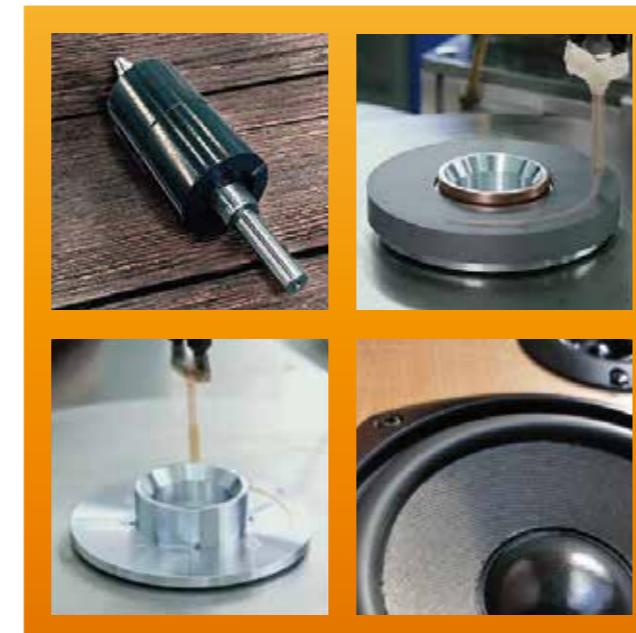
**MXBON®壓克力平面結構膠**具有優異的機械抗性，可滿足需要高剪切強度、抗剝離力、耐衝擊、抑制震動的工業接著或密封應用。單劑型雙步驟操作，預先塗抹促進劑，不須依特定比例混和調配，即可在常溫下快速固定組裝零件，提供高效率、可靠且耐候性極佳的解決方案。
